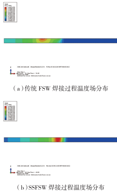
图4 传统FSW与SSFSW焊接过程的温度场分布
